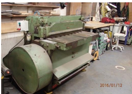
Här skall man inte lägga fingrarna emellan. Klipper lätt 3 mm stålplåt
