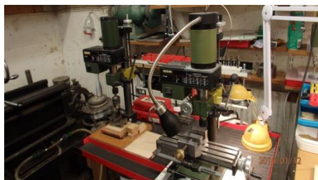
Av Proxxons fräs har Ralph 2 st, varav den ena ombyggd till pelarborr
